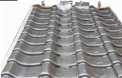
雨漏れ実験風景
