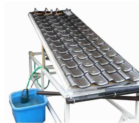
雨漏れ実験風景
