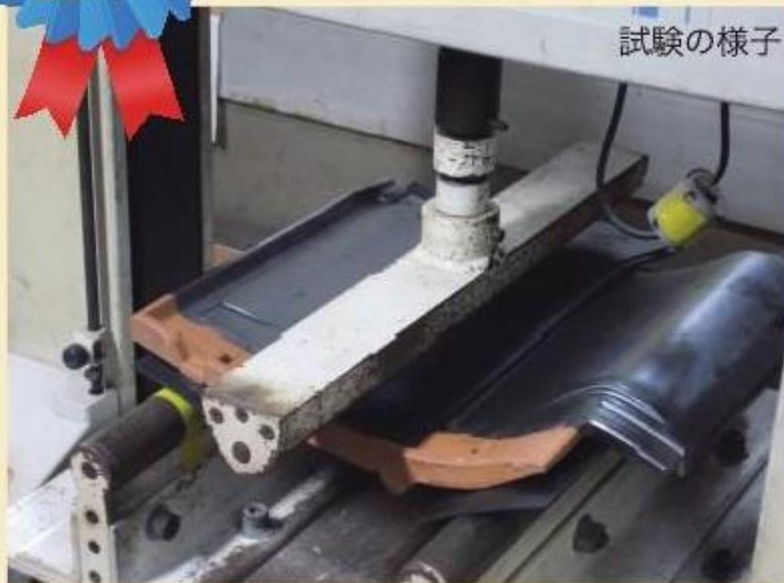
直径 30mm の鋼製丸棒 2 本で支持した後、支持棒と平行させた直径 30mm の鋼製丸棒をスパン中央に用い瓦表面から荷重速度 50N/s で均一に載荷し、曲げ破壊荷重を測定する。
