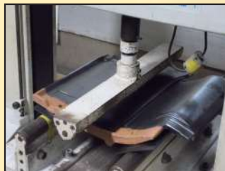
瓦の曲げ試験 JIS A 5208
